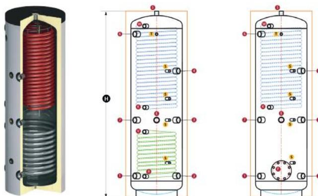
Der Hygiene-Kombispeicher Pipe-Tank erwärmt das Trinkwasser im Durchflussprinzip. Dabei wird die Bevorratung von Trinkwasser gering gehalten, die große Wärmetauscherfläche von 4,5m<sup>2</sup> sorgt für eine gute Wärmeübertragung vom Heizungsmedium auf das Trinkwasser. Die Speicher der Serie Pipe-Tank sind wahlweise entweder mit einem 180mm Flansch, oder einem Glattrohr-Solarregister ausgestattet. Dadurch können zusätzliche Wärmequellen mit aufgenommen werden.
